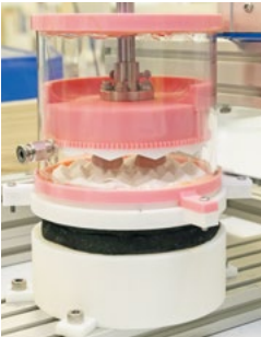
大阪大学と共同で進めている咀嚼試験機による食感と香りの計測
